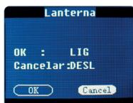
**O modo lanterna pode ser ativado durante o modo de medição:** pressione e mantenha o botão ▲ até que o instrumento ative a lanterna. Para desativar, pressione e mantenha o botão ▼ até que o instrumento desligue a lanterna.
