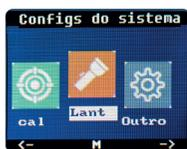
Pressione as teclas ▲ ou ▼ para alternar entre **OK** (liga a lanterna) e **Cancelar** (desliga a lanterna), e em seguida pressione a tecla M/⊙ para sair do modo lanterna.
