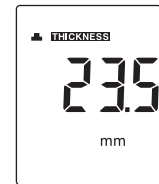
Bom acoplamento na medição
